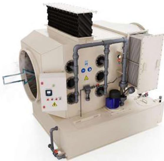
Скруббер – промышленная установка, предназначенная для очистки воздуха, отводимого системами вытяжной вентиляции, путем улавливания аэрозольных и газообразных загрязнений.
