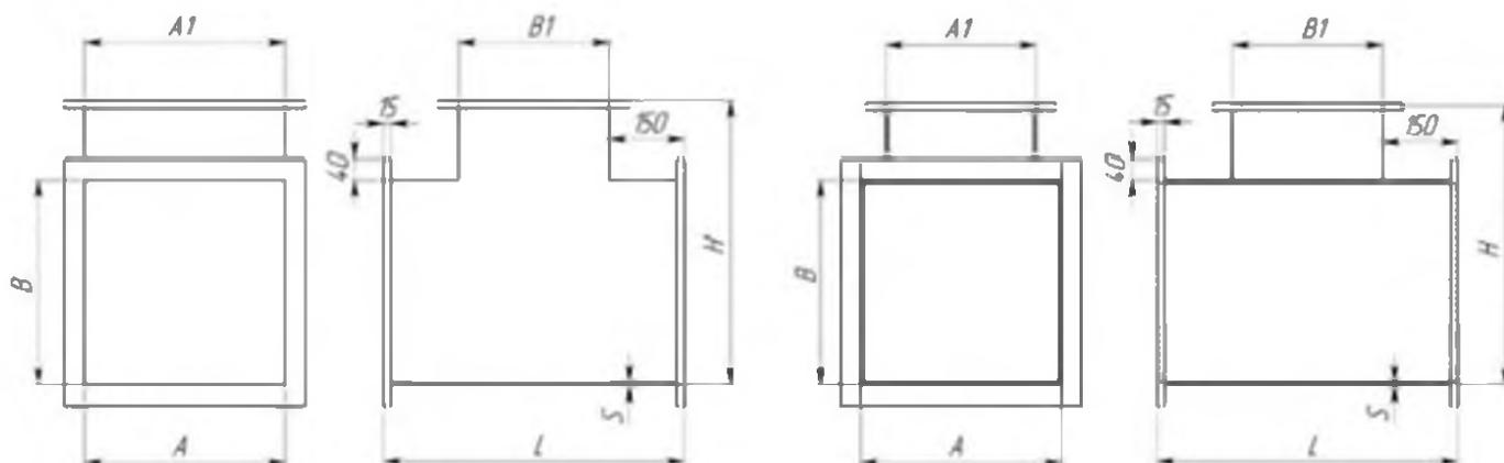
Тройники изготавливаются с сечением от 100 до 300 мм с шагом 50 мм, и с сечением от 400 до 1500 мм с шагом 100 мм в различных комбинациях. Врезка под углом и другие нестандартизированные решения выполняются по запросу.
